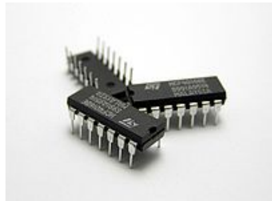
Figura 2. Integrados con encapsulado DIP (Dual In-line Package).
